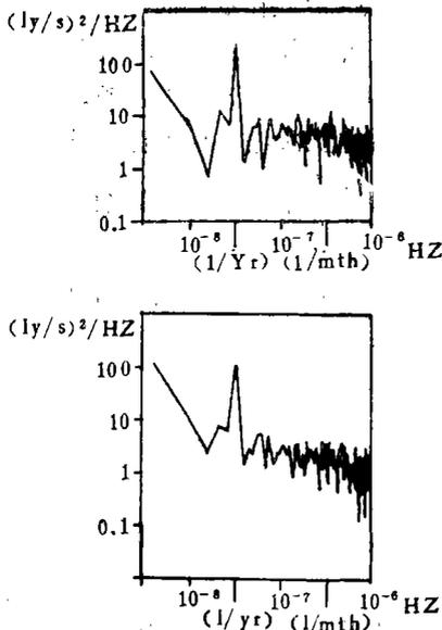
图2 潜热 (上图) 和感热 (下图) 流量输送的频谱
