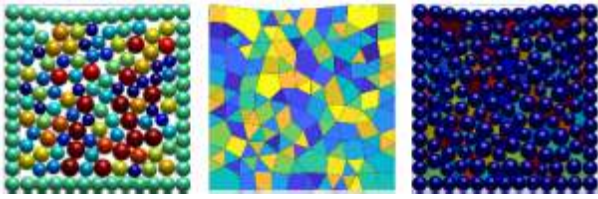
图2 离散元堆积颗粒(a)、孔隙流体域(b)和颗粒-孔隙系统(c)
